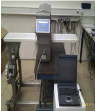
1a. System detekcji miewtali detectronic użyty w testach materiałów wykrywalnych przez detektory metali.
